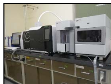
▲パージ・トラップ-ガスクロマトグラフ質量分析計 （揮発性有機化合物・かび臭原因物質の分析）
